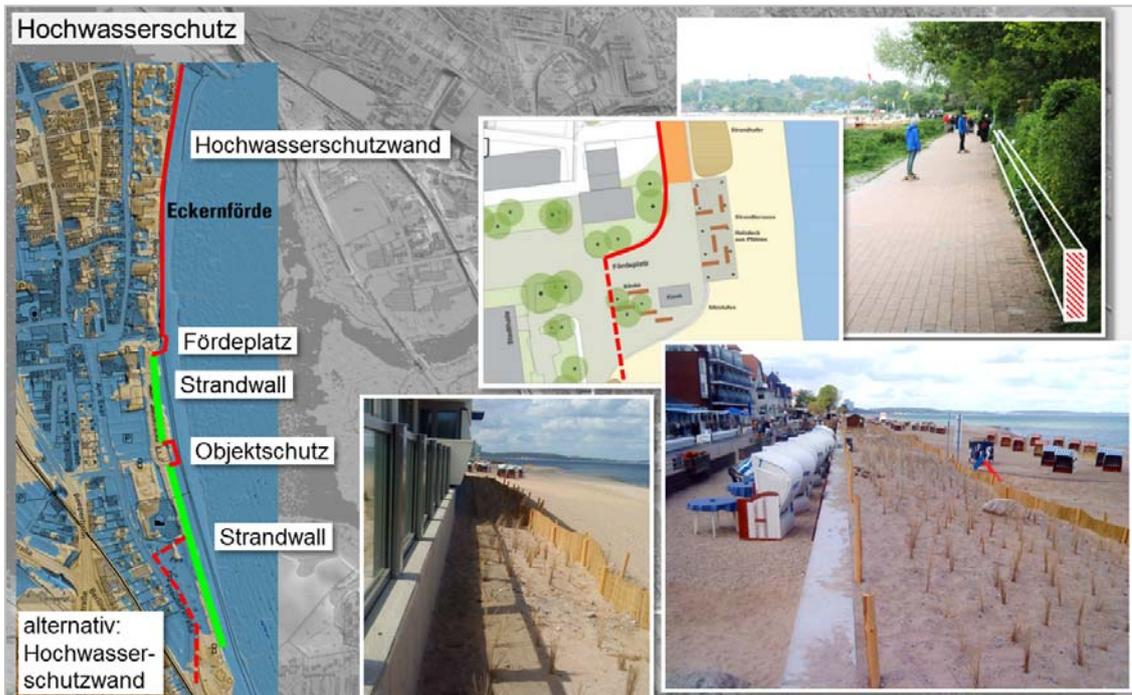
Abb. 31: vorgeschlagene Hochwasserschutzmaßnahmen Bereich Hauptstrand
