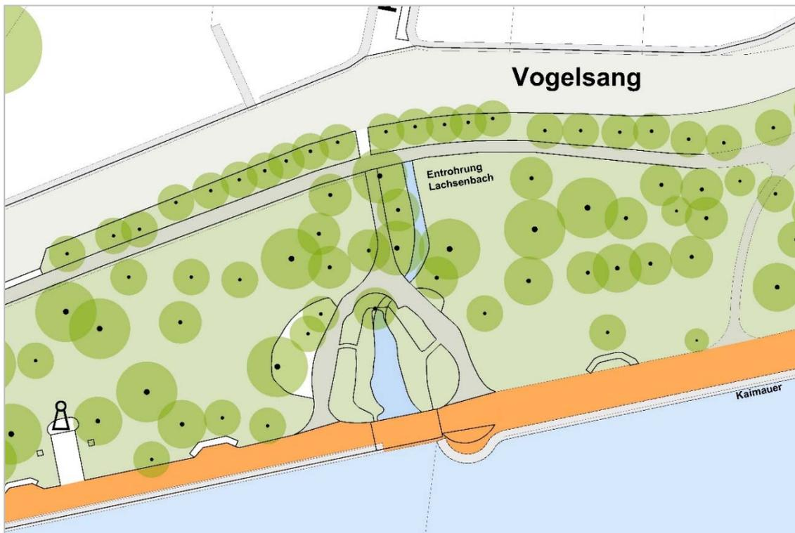
Abb. 18: Konzeptskizze: Entrohrung des Lachsenbaches innerhalb der Parkanlage
