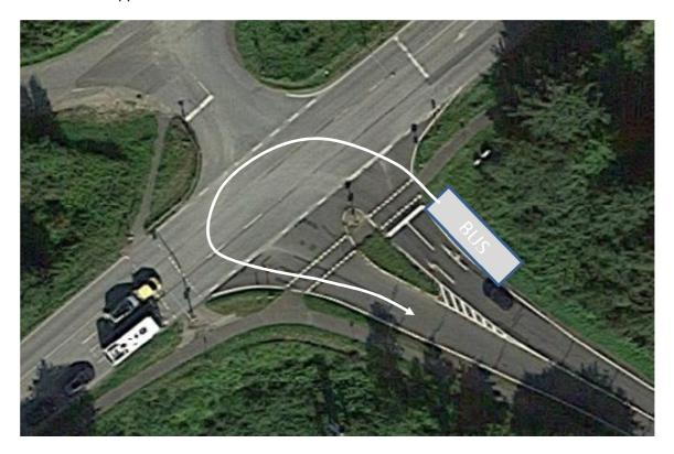
Abbildung 44: Wendemöglichkeit im Bereich des EKZ Holacker – Variante 2
