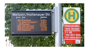
Abbildung 37: Beispiel eines klassischen DFI-Displays in Mastform (Kiel)
