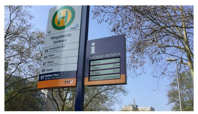
Abbildung 38: Beispiel eines batteriebetriebenen DFI-Displays aus Ludwigshafen
