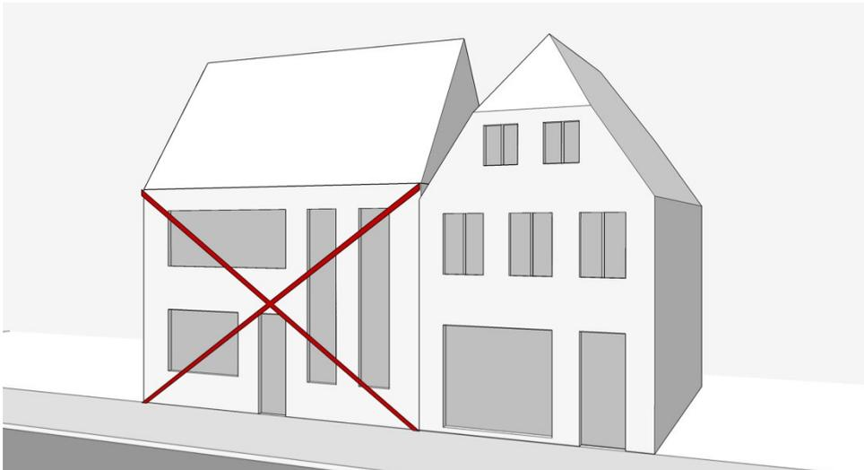
**Abbildung 10: Unzulässigkeit von horizontalen und vertikalen Fensterbändern gemäß § 5 Abs. 2**
