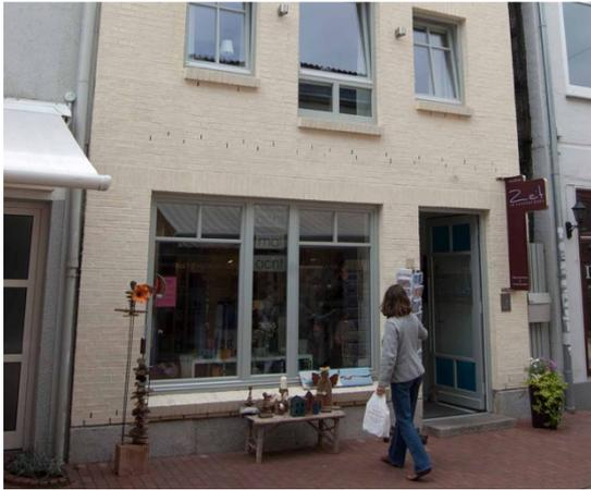
**Abbildung 22: Durch Außenwandflächen eingefasste Schaufensteröffnungen entsprechend § 8 Abs. 2, das Gebäude „steht“ auf dem Boden**
