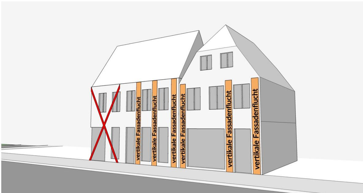
**Abbildung 21: Außenwandflächen aus der vertikalen Fassadenflucht abgeleitet gem. § 8 Abs. 2**
